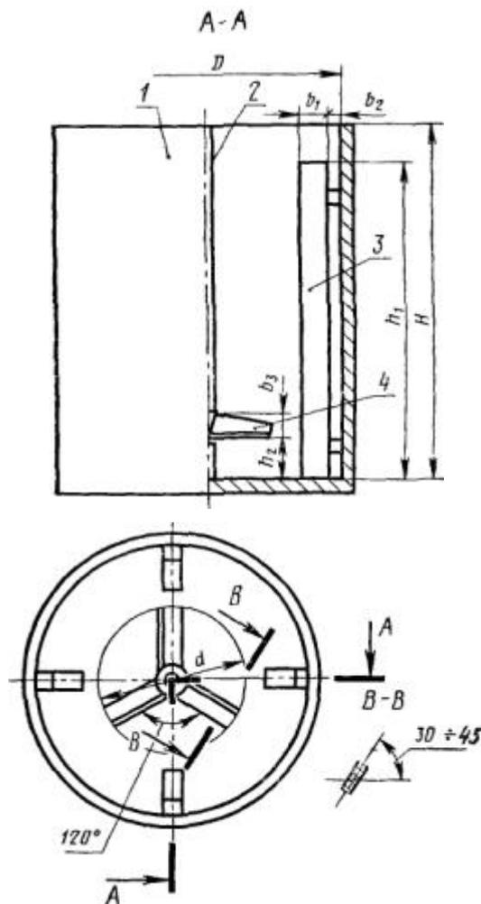
1 - реактор смесителя; 2 - вал смесителя; 3 - отражающая перегородка; 4 - лопасть смесителя
